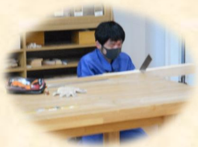
「椅子の部材づくり (脚の切断)」
